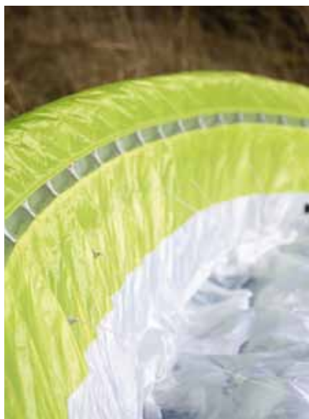
Non visibles, des jongs arment presque toute la corde en extradors, jusqu'à environ 50 cm du bord de fuite. Pour l'anecdote, quand les frères Valic travaillaient sur les protos compétition de différentes marques, ils glissaient des rotatifs entre les coutures. À droite, une protection sérieuse pour les têtes de jongs.
