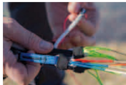
Les élévateurs version light, pas en drisse comme habituellement, mais en fine sangle Dyneema. Avec Softlinks gainés.
