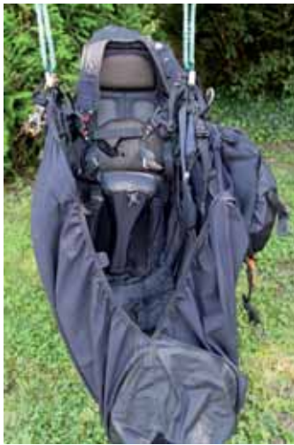
Ci-dessus, le pylône central, supportant le container parachute et porte-instruments. À droite, la pince Kong, solidarisant le container du parachute ventral à la sellette.
