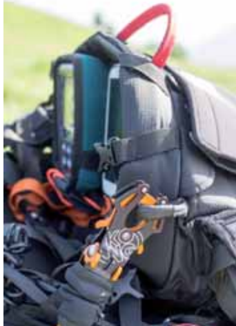
Ci-dessus, le pylône central, supportant le container parachute et porte-instruments. À droite, la pince Kong, solidarisant le container du parachute ventral à la sellette.
