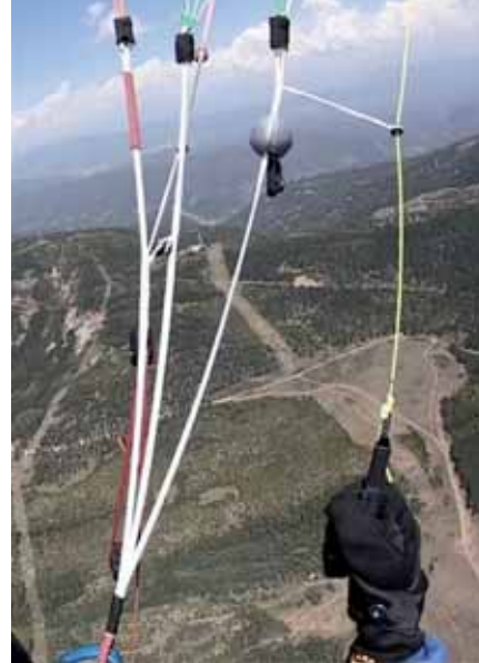
Disponibles en option, les élévateurs light avec soft-links, font gagner 200 grammes. En conservant la boule de pilotage sur les C.
