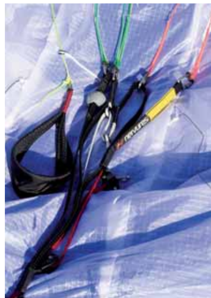
Les élévateurs, très bien faits. Suspentes basses gainées, boule de pilotage sur les C et la poignée souple Nervures, très confortable en dragonne.
