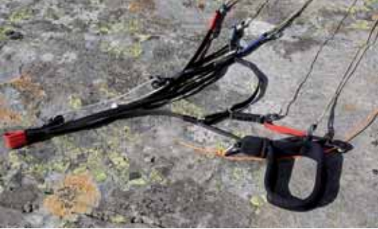
Les élévateurs, embase élargie, poignée de freins confortable et petite sangle rouge pour le pilotage en C-Bridge.
