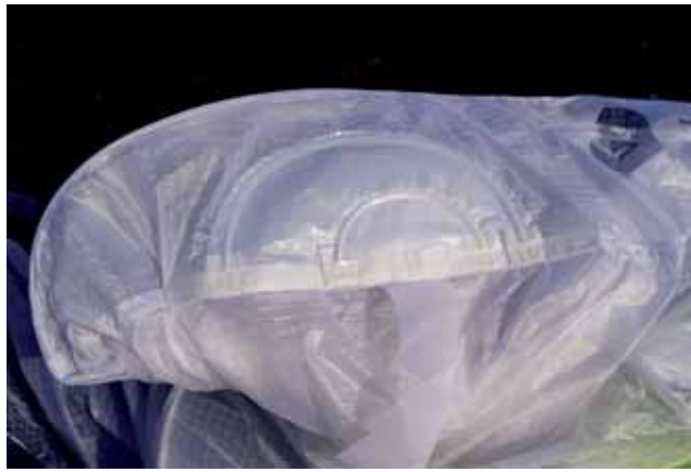
La répartition des efforts aux ancrages des suspentes A : deux joncs en arcs de cercle enserrés dans un épais renfort tissu. La qualité de réalisation est remarquable.
