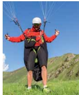
Jean-Michel Ara-Somohano au gonflage. Structure en sangles Dyneema 12 mm, cuissarde droite cousue pour éviter les oublis d'accrochage.
