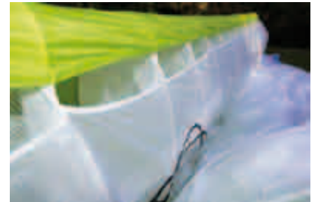
Shark-nose, longs joncs en intrados, ancrages des A très reculés et qualité de fabrication parfaite...
